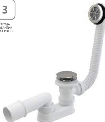
Предназначен для мини-ванны Sabina с отверстием для сифона Ø52 мм. Слив воды и заполнение поддона осуществляется с помощью системы ClickClack (при нажатии на сифон слив закрывается, при повторном нажатии слив открывается).
