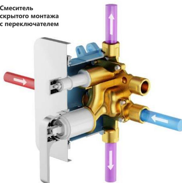
Оба вывода должны быть подключены к трубопроводу. При монтаже на ванну, вывод ванны должен быть на нижнем выходе, а ручной душ должен быть подключен к верхнему выводу. При установке в душевом уголке ручной душ должен быть подключен к нижнему выводу, а верхний душ – к верхнему выводу.
