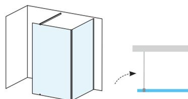
**Рекомендуем:** Устанавливать непосредственно на пол со встроенным душевым каналом
