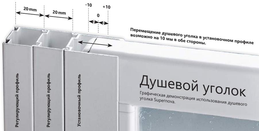
Перемещение душевого уголка в установочном профиле возможно на 10 мм в обе стороны.
