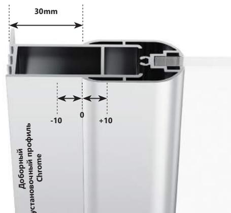
Если вам нужно расширить изделие больше, вам необходимо купить новый дополнительный регулировочный профиль, который на 20 мм шире и позволит расширить изделие еще на 20 мм, сохраняя при этом возможность регулировки +/- 10 мм.
