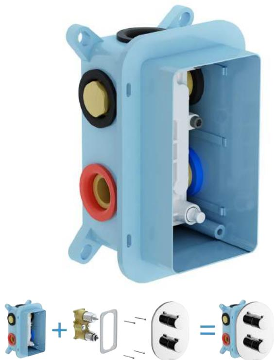
R-box Multi представляет собой скрытую монтажную систему для мультирежимных термостатических скрытых смесителей (CR 067.00). Нижняя часть смесителя, встроенного в R-box, изготовлена из высококачественной латуни, как и верхняя часть смесителя. Установка с базовым блоком проще, быстрее и дает лучшие результаты. Пластиковый корпус защищает внутреннюю часть смесителя при скрытии в стене и упрощает использование.
