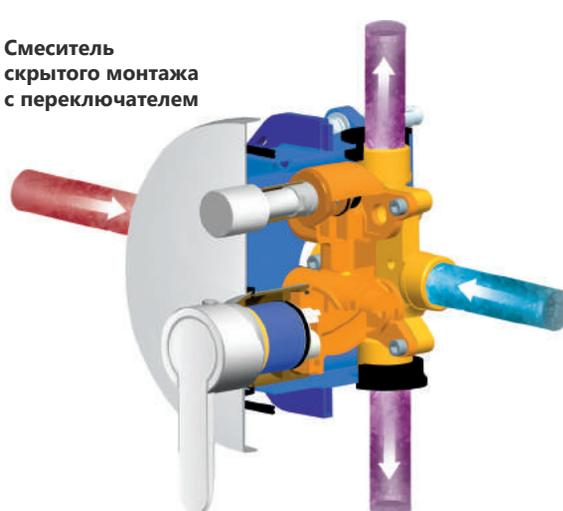
Оба вывода должны быть подключены к трубопроводу. При монтаже на ванну, вывод ванны должен быть на нижнем выходе, а ручной душ должен быть подключен к верхнему выводу. При установке в душевом уголке ручной душ должен быть подключен к нижнему выводу, а верхний душ – к верхнему выводу.
